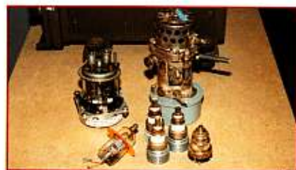
23 cm. cavity met o.a. enkele 2C39 buizen
